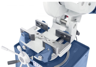
Zentrisch spannender Schraubstock mit längsverschiebbaren Spannbacken
