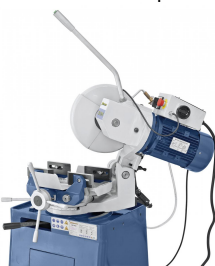
Zentrisch spannender Schraubstock mit längsverschiebbaren Spannbacken
