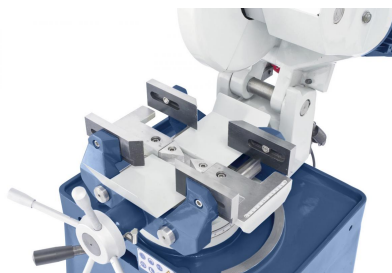
Zentrisch spannender Schraubstock mit längsverschiebbaren Spannbacken
