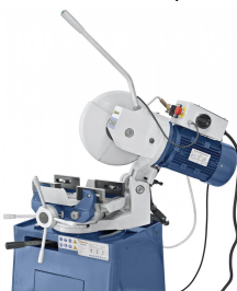
Zentrisch spannender Schraubstock mit längsverschiebbaren Spannbacken
