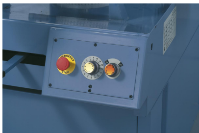
Komfortable Einstellung des Auflagedrucks mittels Regelventil.
