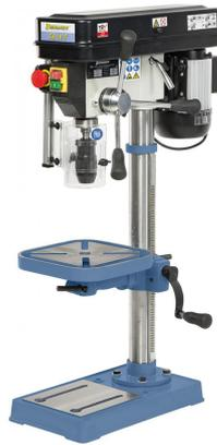
Die preiswerte Tischbohrmaschine TB 16 T mit Keilriemenantrieb ist mit einer Bohrleistung von 16 mm erhältlich. Durch die von Bernardo entwickelte höhenverstellbare Schutzabdeckung werden sowohl der Bohrer als auch das Bohrfutter gänzlich abgedeckt. Dies sorgt für erhöhte Sicherheit und sind daher die ideale Lösung für Bastler und Lehrwerkstätten.
