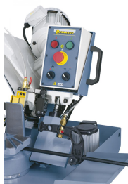
Schaltelemente übersichtlich im Elektropaneel
