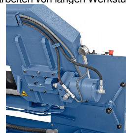
Optional mit hydraulischer Sägebandspannung lieferbar.
