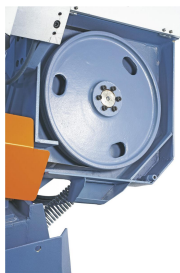
Die dynamisch ausgewuchteten Laufräder aus Grauguss sorgen für einen ruhigen Lauf.
