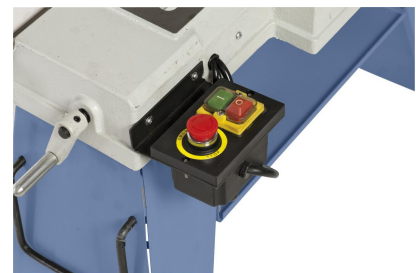
Sicherheitsschalter mit Unterspannungsauslöser und separatem Not-Halt-Taster, automatische Endabschaltung nach Beendigung des Sägevorganges
