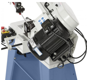
Leistungsstarker Graugußmotor nach IP 54, wahlweise in 230 V oder 400 V erhältlich
