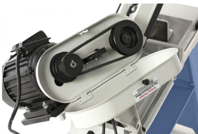
Mittels Keilriemen kann die Bandgeschwindigkeit schnell und einfach gewechselt werden
