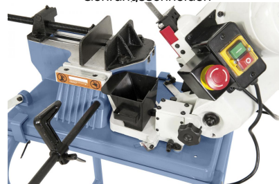
Verstellbarer Sägebügel zum Gehrungsschneiden
