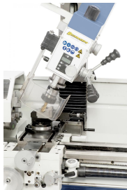
Durch den schwenkbaren Fräskopf ergibt sich eine Vielzahl von Bearbeitungsmöglichkeiten.
