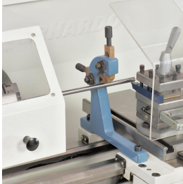
Die mitlaufende Lünette verhindert das Durchbiegen von dünnen Wellen.
