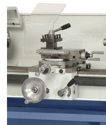
Leichtgängiger und präziser Schlitten mit Obersupport, lange Lebensdauer durch spielfrei nachstellbare Keilleisten
