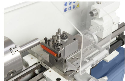
Zur Reduzierung der Nebenzeiten kann die Maschine mit einem Schnellwechselstahlhalter Bernardo Größe 1 ausgestattet werden
