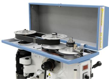
Die Geschwindigkeitsübertragung vom Motor zur Pinole erfolgt über einen soliden Variatorantrieb.
