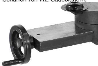
20° rechts / links schwenkbar, ideal zum Schärfen von WZ-Sägeblättern.
