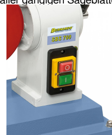
EIN-AUS-Schalter nach IP54 mit Unterspannungsauslöser.
