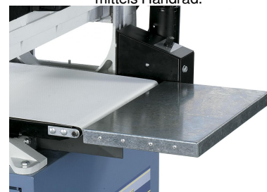
Vergrößerte Auflagefläche durch beidseitige Tischverlängerungen.
