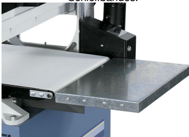
Vergrößerte Auflagefläche durch beidseitige Tischverlängerungen.
