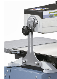
Klemmsystem zum Fixieren der Schleifeinheit.
