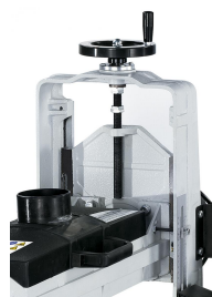
Stabiles Führungssystem, Höhenverstellung mittels Handrad.
