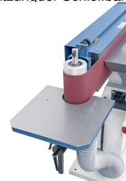
Rundschleiftisch mit Absauganschluss ideal zum Schleifen von Radien und Konturen.
