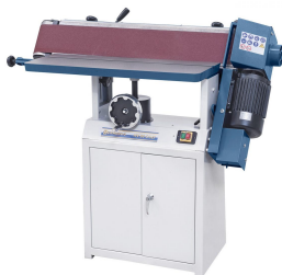
Schleifaggregat kann in jeder beliebigen Position von 0^\circ - 90^\circ stufenlos geklemmt werden
