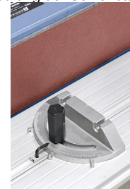
Höhenverstellbarer Arbeitstisch zur optimalen Ausnutzung der Schleifbandbreite
