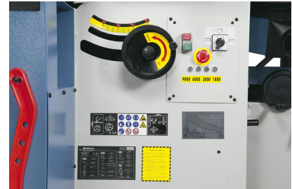
Benutzerfreundliche Schalt- und Bedienelemente, elektronische Drehzahlanzeige mittels LED
