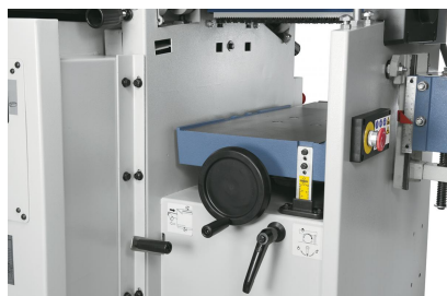
Stabiler Dickentisch aus Grauguss mit mittiger Zentralführung und Klemmung, zum Hobeln von Werkstücken bis 225 mm Höhe.
