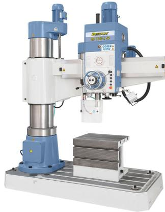
Die Radialbohrmaschine RD 1300 NC Vario ist für Bohr-, Senk- und Reibarbeiten von großen Werkstücken (wie z.B. Stahlträger, Flansche....) ideal geeignet. Die Besonderheiten dieses Modells sind die Bedienung über einen großdimensioniertem Touchscreen sowie der Pinolenvorschub mittels Servomotor. Durch die vielseitigen Anwendungsmöglichkeiten ist diese Maschine optimal für mechanische Werkstätten, Reparaturbetriebe, Maschinenbau, ...
