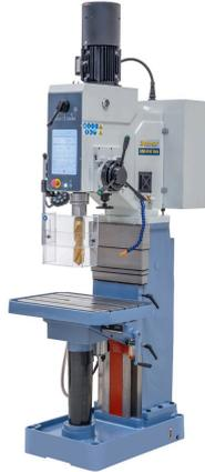
Die Kastenständerbohrmaschine KBM 65 NC Vario ist serienmäßig mit einer stufenlosen Drehzahlregelung ausgestattet, wodurch die Schnittgeschwindigkeit optimal an das Werkstück angepasst werden kann. Die Besonderheiten dieses Modells sind die Bedienung über einen großdimensioniertem Touchscreen sowie der Pinolenvorschub mittels Servomotor.
