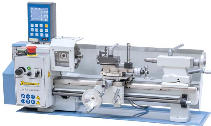
Die Tischdrehmaschine Hobby 350 Vario bietet zusätzlich - im Gegensatz zur Hobby 300 Vario - eine um 50 mm größere Spitzenweite sowie einen stärkeren Antriebsmotor. Zur Reduzierung der Fertigungszeiten kann dieses Modell mit einer 2-Achs-Digitalanzeige geliefert werden.
