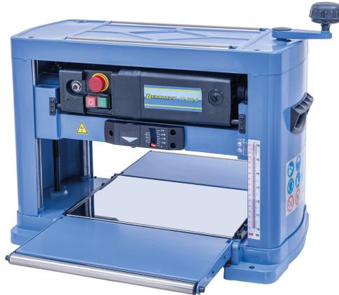
Die Dickenhobelmaschine TH 330 S ist durch die kompakte Bauweise leicht zu transportieren und das ideale Arbeitsgerät für den Baustelleneinsatz. Durch das 4-fach geführte Hobelaggregat und der gummierten Ein- und Auszugswalze für sicheren Werkstückvorschub wird ein plangenaues Hobeln garantiert.
