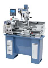
Das Bearbeitungszentrum Proficenter 650 G ist serienmäßig mit einer Leitspindel zum Gewindeschneiden bzw. für den automatischen Längs-und Planvorschub ausgestattet. Durch das 12-Stufen-Schaltgetriebe wird ein schnelles Einstellen der Drehzahlen ermöglicht - kein Keilriemenwechsel notwendig. Die Maschine ist serienmäßig mit einer digitalen Positionsanzeige Bernardo ausgestattet.
