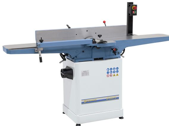
Die Abrichthobelmaschine SP 200 PS ist das ideale Einsteigermodell zum plangenaugen Abrichten, Fügen und Anfasen von Brettern, Leisten, Balken, usw. Die schwere Gussausführung und die präzise Konstruktion erfüllen die hohen Ansprüche der ambitionierten Heim- und Handwerker.
