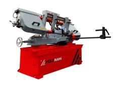
Die HOLZMANN Metallbandsäge BS450 in massiver Ausführung mit kraftvollen Motor mit Riemenantrieb. 4 Sägebandgeschwindigkeiten sind durch Riemenumlage einstellbar (25|40|51|71 m/min). Große Schnittleistung von 450 x 200 mm möglich.
