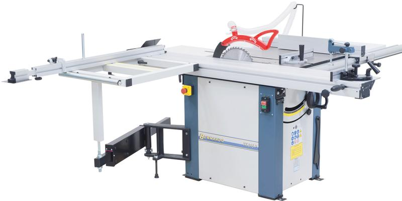
Die Formatkreissäge TK 315 P ist je nach Anwendung wahlweise mit drei verschiedenen Tischlängen lieferbar (1600 / 1800 / 2000 mm). Serienmäßig ausgestattet mit einem 3,0 kW Motor und einem Sägeblatt mit 315 mm Durchmesser für Schnitthöhen bis 100 mm, sowie einem Vorritzaggregat für ein ausreißfreies Bearbeiten beschichteter Plattenwerkstoffe.
