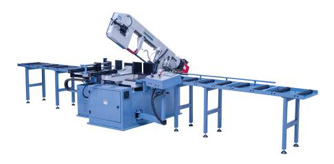
Das Modell CGS 330 VAG ist eine vollautomatische Gehrungsbandsäge (bis 60°) mit umfangreicher Ausstattung (wie z.B. PLC-Steuerung, stufenlose Bandgeschwindigkeit, automatische Bandbruchkontrolle,....). Die integrierte PLC-Steuerung ermöglicht ein vordefinieren der benötigten Stückzahl und Schnittlänge, wodurch eine wirtschaftliche Serienfertigung gewährleistet wird.
