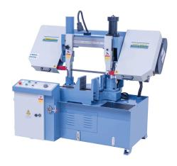
Die Doppelsäulen-Gehrungsbandsäge CBS 280 G hat den wesentlichen Vorteil, dass die Zustellung des Sägerahmens über eine präzisionsgeschliffene Säulenführung erfolgt. Dadurch eignet sich diese Maschine ideal zum Bearbeiten von Blöcken aus Vollmaterial. Zum Schneiden von Gehrungen kann der Sägebügel von 0° bis 45° in jedem gewünschten Winkel eingestellt werden.
