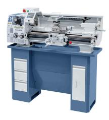
Die Drehmaschine Profi 650 G ist serienmäßig mit einer Leit- und Zugspindel zum Gewindeschneiden bzw. für den automatischen Längs- und Planvorschub ausgestattet. Durch das 12-Stufen-Schaltgetriebe wird ein schnelles Einstellen der Drehzahlen ermöglicht - kein Keilriemenwechsel notwendig. Durch ihre kompakte Bauweise und das hohe Eigengewicht bietet diese Maschine eine hohe Laufruhe und garantiert dadurch präzises Arbeiten.
