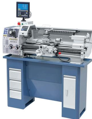
Die Drehmaschine Profi 650 G ist serienmäßig mit einer Leit- und Zugspindel zum Gewindeschneiden bzw. für den automatischen Längs- und Planvorschub ausgestattet. Durch das 12-Stufen-Schaltgetriebe wird ein schnelles Einstellen der Drehzahlen ermöglicht - kein Keilriemenwechsel notwendig. Durch ihre kompakte Bauweise und das hohe Eigengewicht bietet diese Maschine eine hohe Laufruhe und garantiert dadurch präzises Arbeiten.
