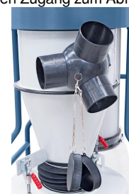
Serienmäßig mit Schnellspannhebel für einen einfachen Zugang zum Abfüllbehälter
