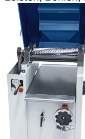
Stabiler Dickentisch mit Pinolenführung und Abstützung für exaktes Hobeln von Bretter, Leisten, Bohlen, ...
