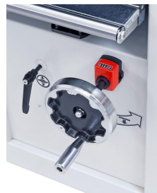
Die Einstellung der Dickentischhöhe erfolgt mittels digitaler Anzeige auf 1/10 mm genau.
