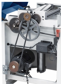
Der Kettenantrieb sorgt für einen gleichmäßigen Antrieb der Ein- und Auszugswalze.
