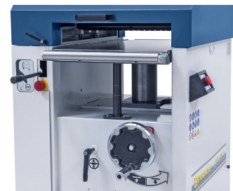
Stabiler Dickentisch mit Pinolenführung und Abstützung für exaktes Hobeln von Bretter, Leisten, Bohlen, ...
