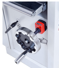
Die Einstellung der Dickentischhöhe erfolgt mittels digitaler Anzeige auf 1/10 mm genau.
