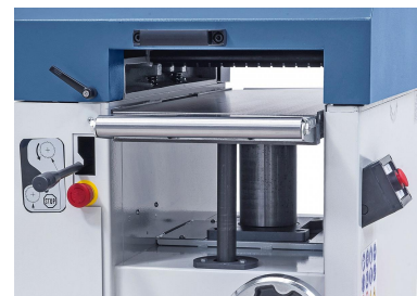
Stabiler Dickentisch mit Pinolenführung und Abstützung für exaktes Hobeln von Bretter, Leisten, Bohlen, ...
