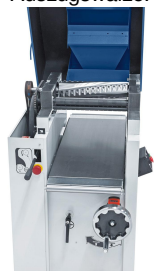
Der Kettenantrieb sorgt für einen gleichmäßigen Antrieb der Ein- und Auszugswalze.
