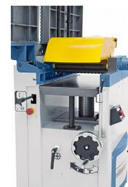
Das Hobelwerk besteht aus einer dynamisch ausgewuchteten Spiralmesser-Messerwelle, einer Ein- und Auszugswalze, sowie massiven
