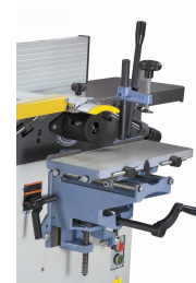
Die Langlochbohrereinrichtung ist ideal für Langlöcher, Dübel- und Schräglochbohrungen (Option)
