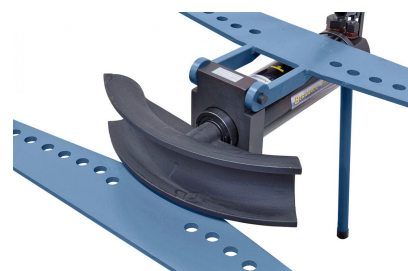
Stabile Biegeformen aus Grauguss.
