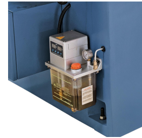
Alle Führungsbahnen und Spindeln werden automatisch geschmiert
