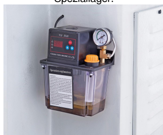
Automatische Zentralschmierung für alle Führungsbahnen und Spindeln.
