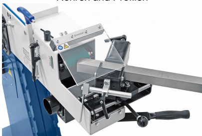
Schwenkbare Schleifeinrichtung von 30° bis 90°
