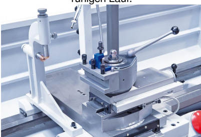
Vorschubgetriebe leicht und präzise schaltbar, geschliffene Zahnräder sorgen für einen ruhigen Lauf.
