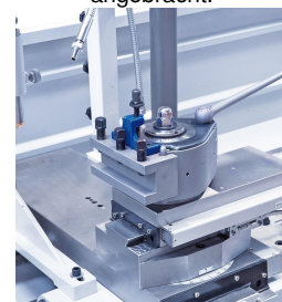
Zum rationellen Arbeiten ist die Maschine serienmäßig mit einem Schnellwechselstahlhalter ausgerüstet.
