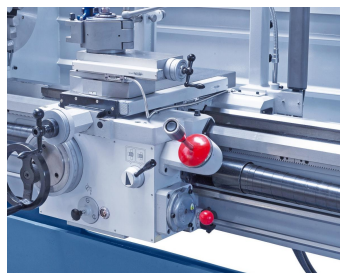
Serienmäßig mit Eilgang zur Reduzierung der Nebenzeiten
