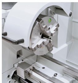
Zentrisch spannendes 4-Backenfutter 160 mm, optimal für Vierkant-Werkstücke (Option).
