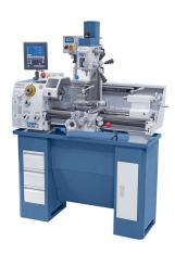
Das Bearbeitungszentrum Proficenter 600 G ist serienmäßig mit einer Leit- und Zugspindel zum Gewindeschneiden bzw. für den automatischen Längs- und Planvorschub ausgestattet. Durch das 12-Stufen-Schaltgetriebe wird ein schnelles Einstellen der Drehzahlen ermöglicht - kein Keilriemenwechsel notwendig. Die Maschine ist serienmäßig mit einer digitalen Positionsanzeige Bernardo ausgestattet.
