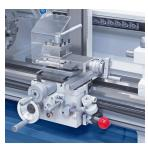
Leichtgängiger Schlitten mit Obersupport und Feststehende Lünette mit Bronzeführung zum Vierfachstahlhalter, Handräder mit einstellbarer metrischer Feinskalierung
