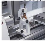
Stabilisieren von langen Werkstücken.
