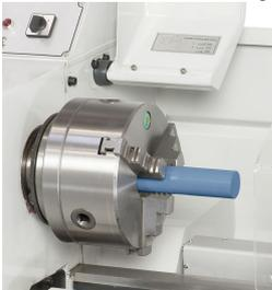
3-Backenfutter in Stahlausführung mit Dreh- und Bohrbacken im Lieferumfang enthalten
