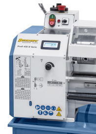
Elektronisch, stufenlose Drehzahlregelung, leichtes Ablesen mittels Digitalanzeige.
