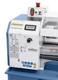
Elektronisch, stufenlose Drehzahlregelung, leichtes Ablesen mittels Digitalanzeige.
